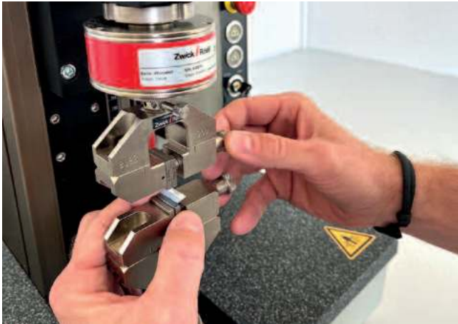
Einspannen einer Blisterverpackung zur Siegelnahtprüfung: Die zwickiLine von ZwickRoell wird bei Eberle für Peeltests an Tyvek-Blistern nach ASTM F88/F88M eingesetzt (Bilder, Quelle: ZwickRoell GmbH & Co. KG)
