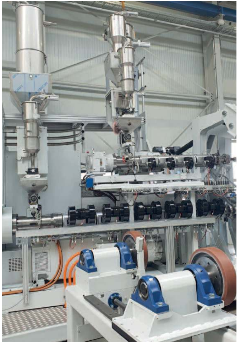
Das Herzstück der neu entwickelten Wickelrohranlage „100% made by boyke“ – der optimierte Extruder mit Co-Extruder für mehrfarbige Wickelrohre
