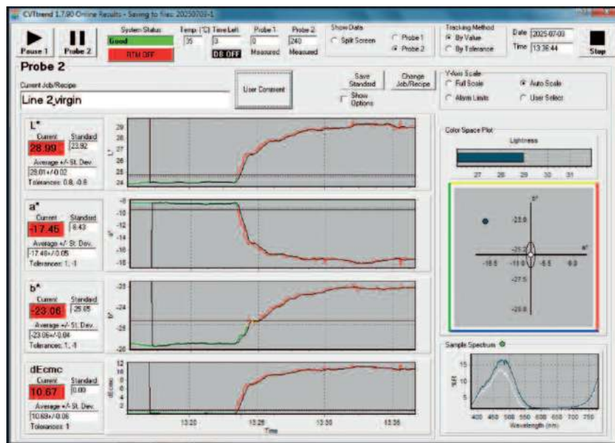
Bild 2: Echtzeit Trenddiagramm Rezepturwechsel
