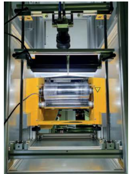
Das Inspektionssystem ist komplett in die Flachfolienextrusionsanlage integriert und erlaubt es, die Belagsbildung im laufenden Prozess zu verfolgen und aufzuzeichnen (Quelle IKV)
