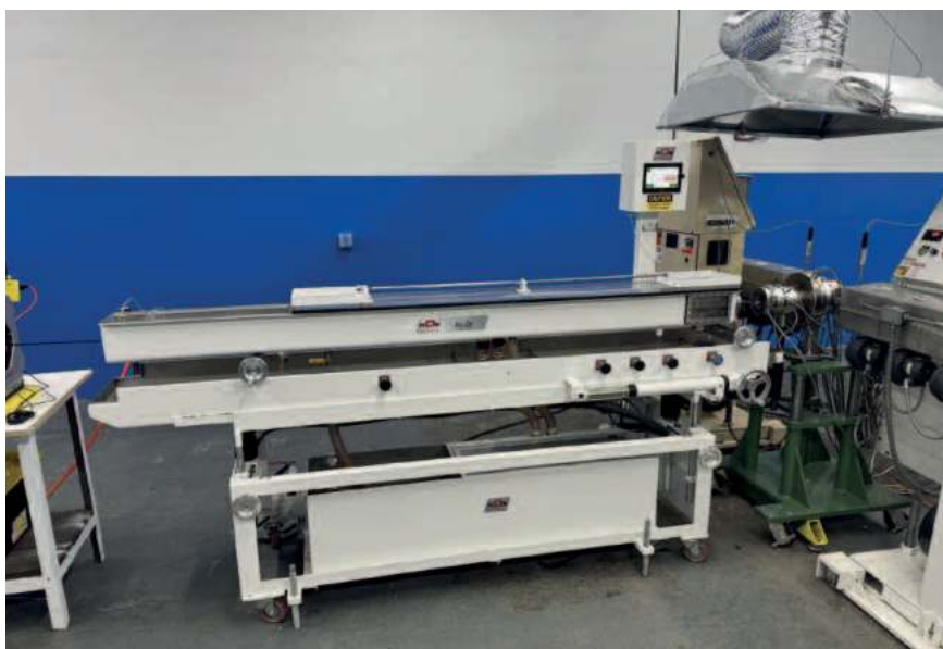
Fließbett in der Test-Extrusionsanlage
