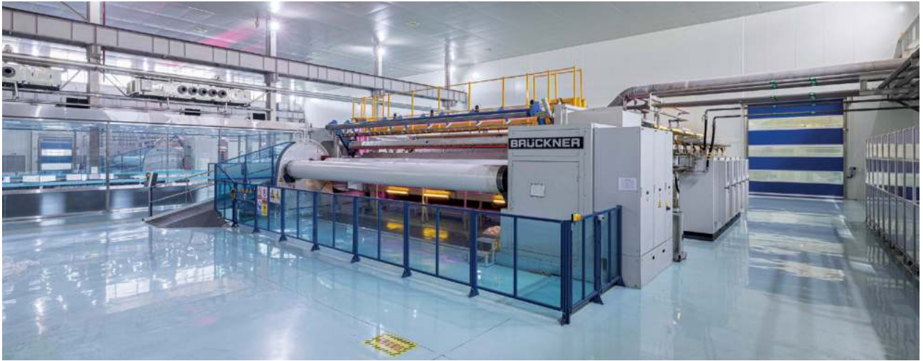
Brückner Maschinenbau setzt bei seinen Kunststoff-Streckfolien-Anlagen auf ZSK Extruder von Coperion, die die Aufschmelzung der Rohmaterialien für die Beschickung übernehmen (Bild: Brückner Maschinenbau)
